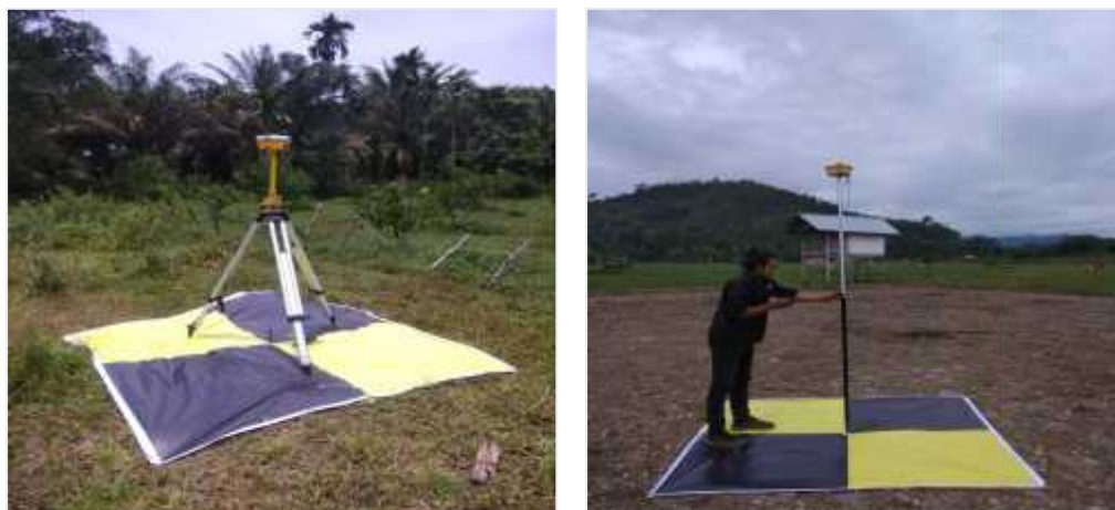
Gambar 4. Pemasangan Benchmark dan Pengambilan Koordinat Menggunakan GPS Geodetik
