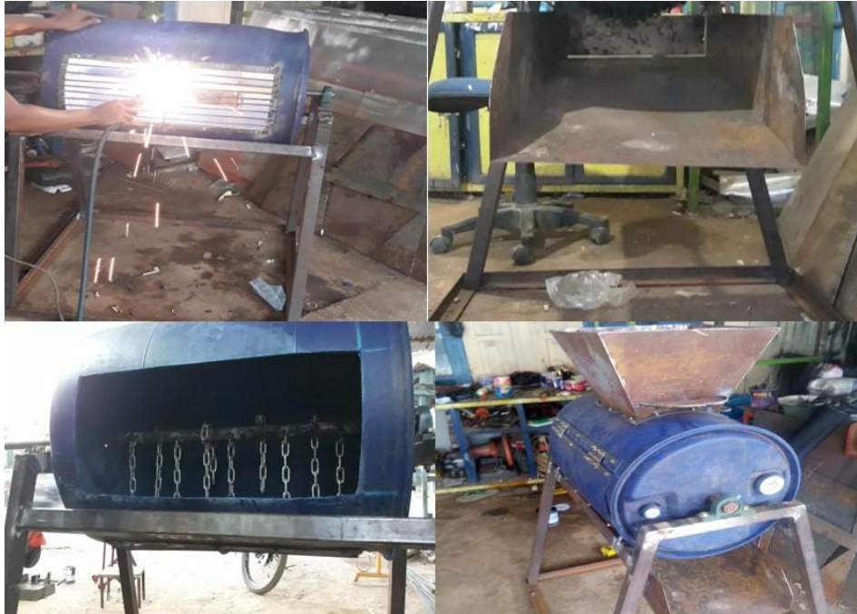
Gambar 3. Proses Pengerjaan Alat Pemipil Jagung
