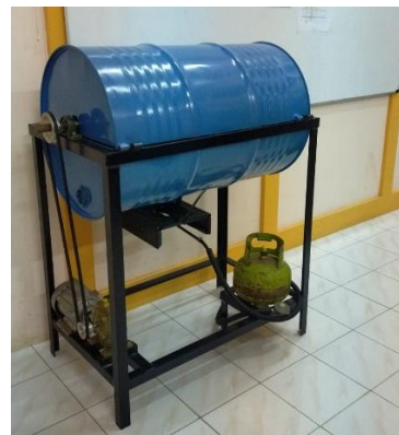
Gambar 11. Mesin pengering daun sereh setelah dirakit
