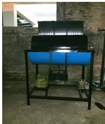
Gambar 11. Mesin pengering daun sereh setelah dirakit
