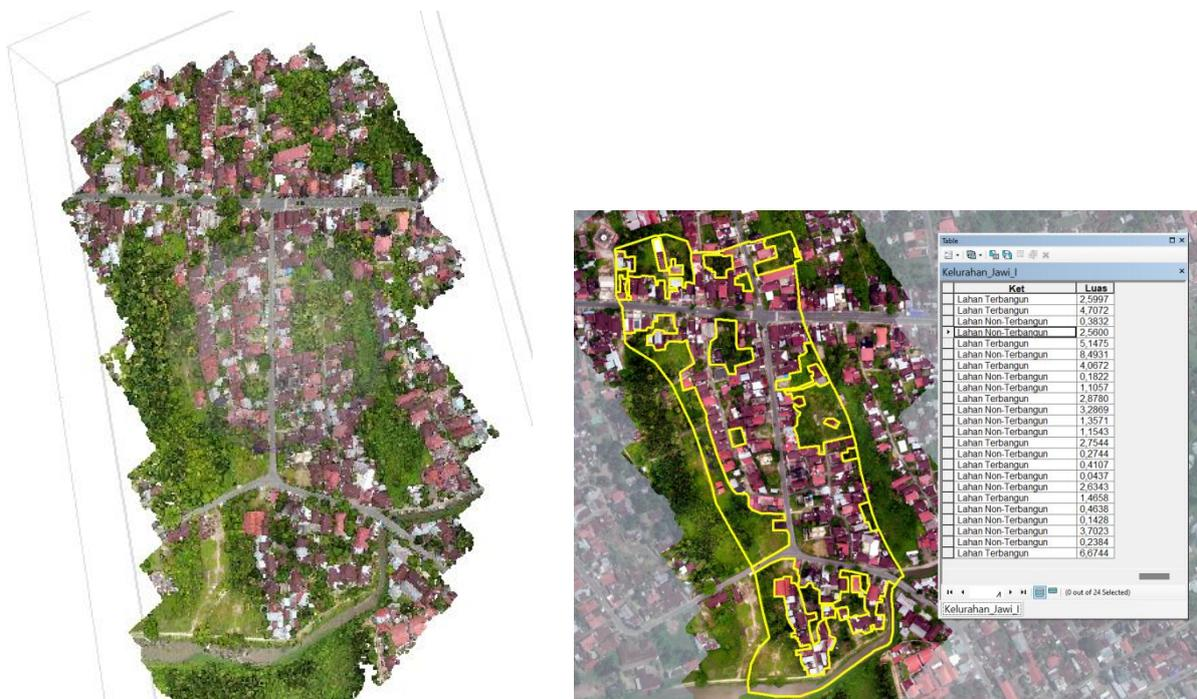
Gambar 6. Hasil Data Orthomosaik Foto Udara UAV dan Estimasi Lahan Terbangun
