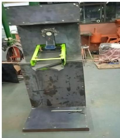
Gambar 4. Pembuatan Bodi Mesin *Rice Milling*
