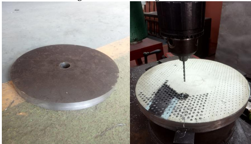
Gambar 5. Pengeboran Filter Pencetak
