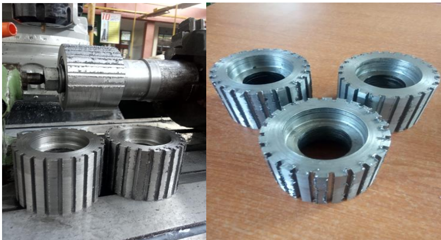
Gambar 3. Pembubutan Shaft Roller
