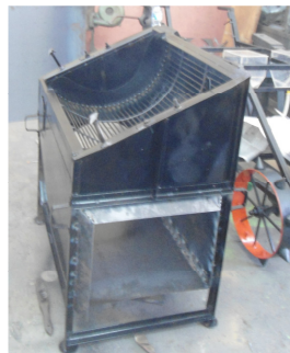
Gambar 11. Lorong Penghembus Pada Mesin Perontok
