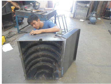
Gambar 10. Komponen Bagian Atas Perontok sistem lorong hembus
