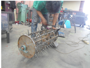
Gambar 9. Roda Perontok Pada Mesin Perontok Sistem Lorong Hembus
