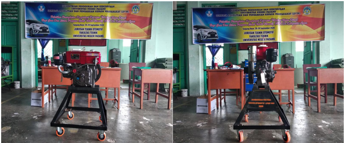
Gambar 1. Spanduk kegiatan Pengabdian kepada Masyarakat dan Engine stand Motor diesel 4 tak 1 silinder.
