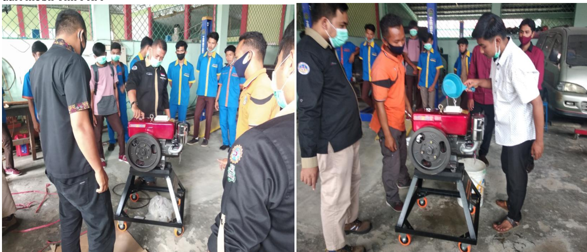
Gambar 4. Mesin diesel telah terpasang pada dudukannya. Gambar 5. Pengisian air pendingin sebelum mesin
