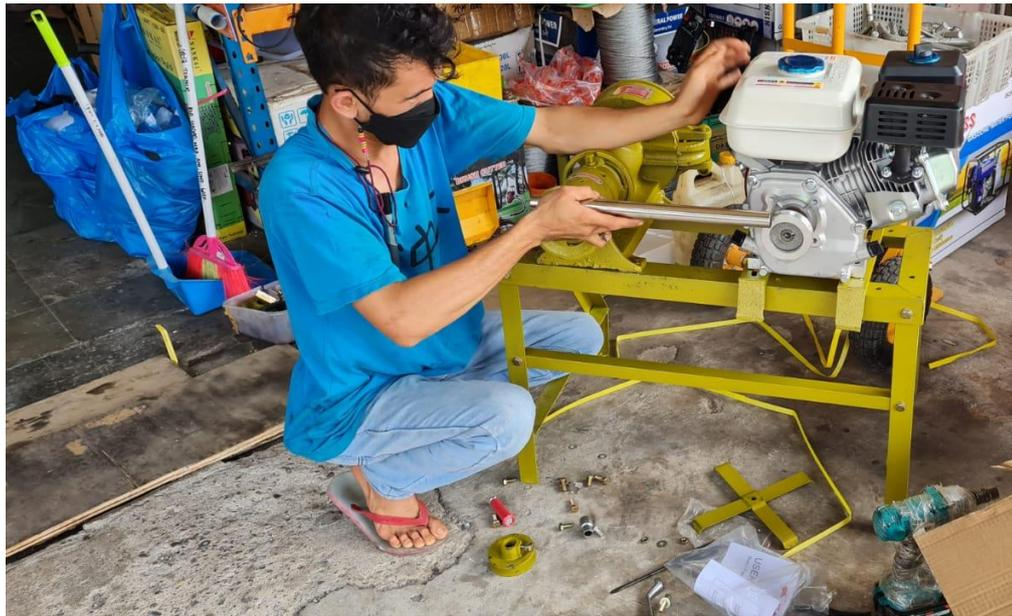
Gambar 7. Perakitan mesin giling
