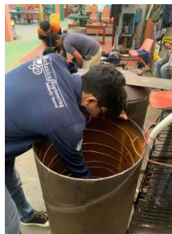
Gambar 7. Proses Pemasangan Lilitan Pendingin.
