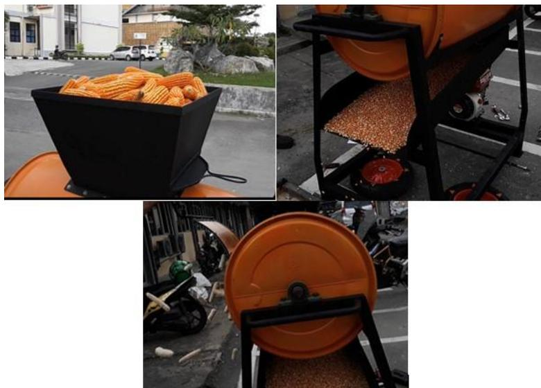
Gambar 6. Proses Uji Kinerja Alat Pemipil Jagung
