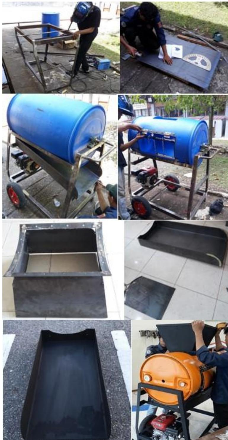
Gambar 4. Proses Pengerjaan Alat Pemipil Jagung
